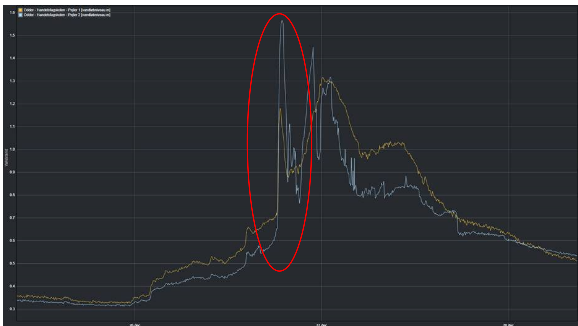
Figur 19. Vandstanden i Stampmølle Bæk ved Rådhusgade i perioden d. 25-28 dec. 2015. Data viser at vandstanden kan stige hurtigt og at beredskabet derfor skal kunne reagere hurtigt for at holde risten fri for materialer.
