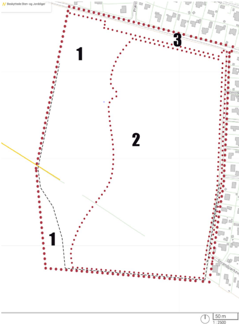
Vedr. beskyttet jorddige: Kort visende lokalplanområdets afgrænsning, delområdenumre, del af beskyttet jorddige (orange streg) samt indledende foreslået placering af nyt dige (klimatilpasning), som krydser det eksisterende.
